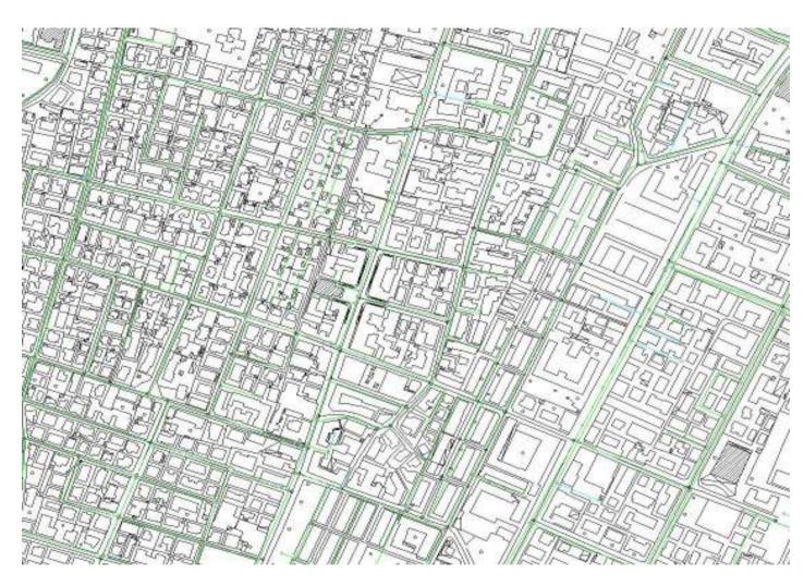
Disegno della rete idrica georeferenziato nel sistema GAUSS-BOAGA
