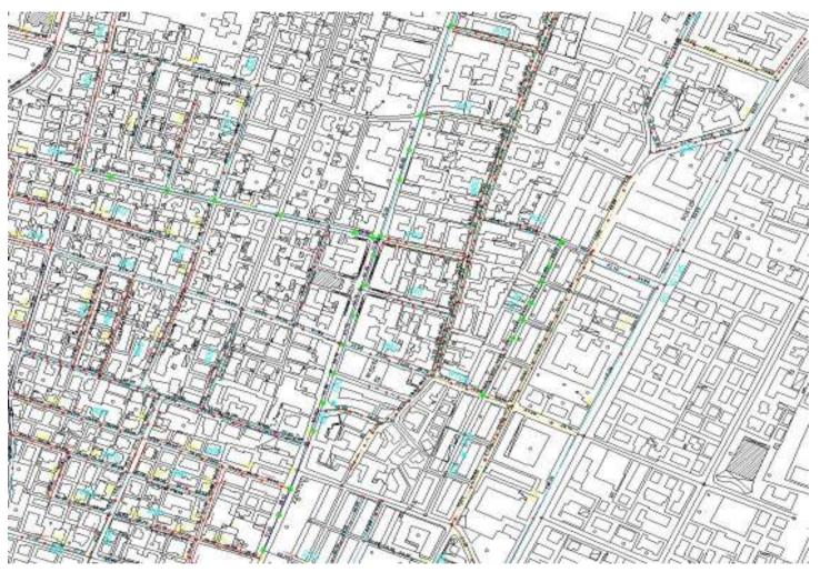
Disegno della rete fognaria rilevato e tracciato nel sistema GAUSS-BOAGA. Da quando il servizio è in gestione dell'azienda si sta procedendo al rilievo e tracciatura vettoriale della rete fognaria per l'implementazione del sistema informativo territoriale
