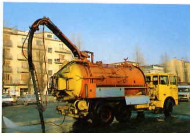
Il getto d'acqua ad alta pressione permette di eliminare il terriccio che ostruisce i pozzetti.
