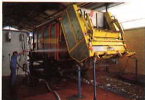
A fine turno tutti gli autocompattatori di rifiuti entrano nel tunnel di lavaggio
